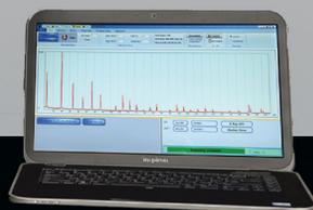
ポルトランドセメントは4つ主要な相で構成されています: エーライト(C<sub>3</sub>S), ベーライト(C<sub>2</sub>S), フェライト(C<sub>4</sub>AF)とアルミン酸塩(C<sub>3</sub>A)に石膏、遊離石灰、ペリクレーズ、アーカナイト等のいくつかのマイナー構成物が加えられています。サンプル内の相/物質はそれぞれの特徴的な回折パターンを持ち、そのパターン強度はサンプル内における相/物質の相対量に比例します。強力なJADEの粉末回折ソフトウェアとのコンビネーションによって、複雑な混合物であっても、簡単に相特定や定量評価が可能です。
