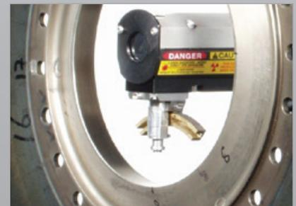
内径の残留応力測定
