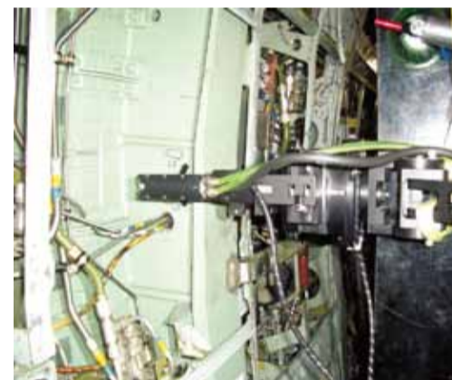
iXRD ポータブルシステムによる飛行機の残留応力測定
